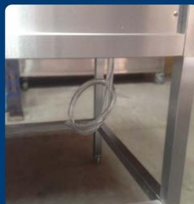
. Incluye válvula y manguera para descarga de agua.
